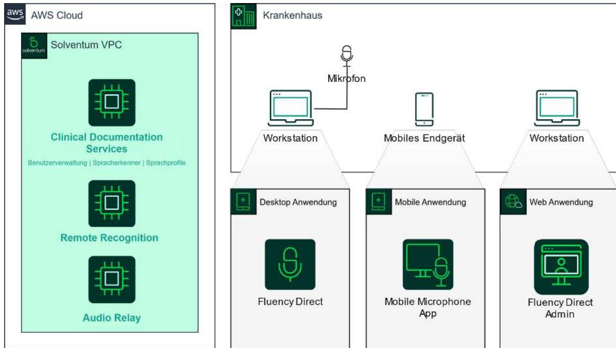
Das obige Architekturdiagramm zeigt einen Überblick über die Systemstruktur und die einzelnen Komponenten der angebotenen Lösung.
